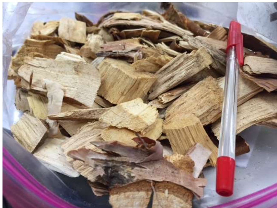
欧州の量産型ダウンドラフト炉の燃料チップ 水分率 15%
